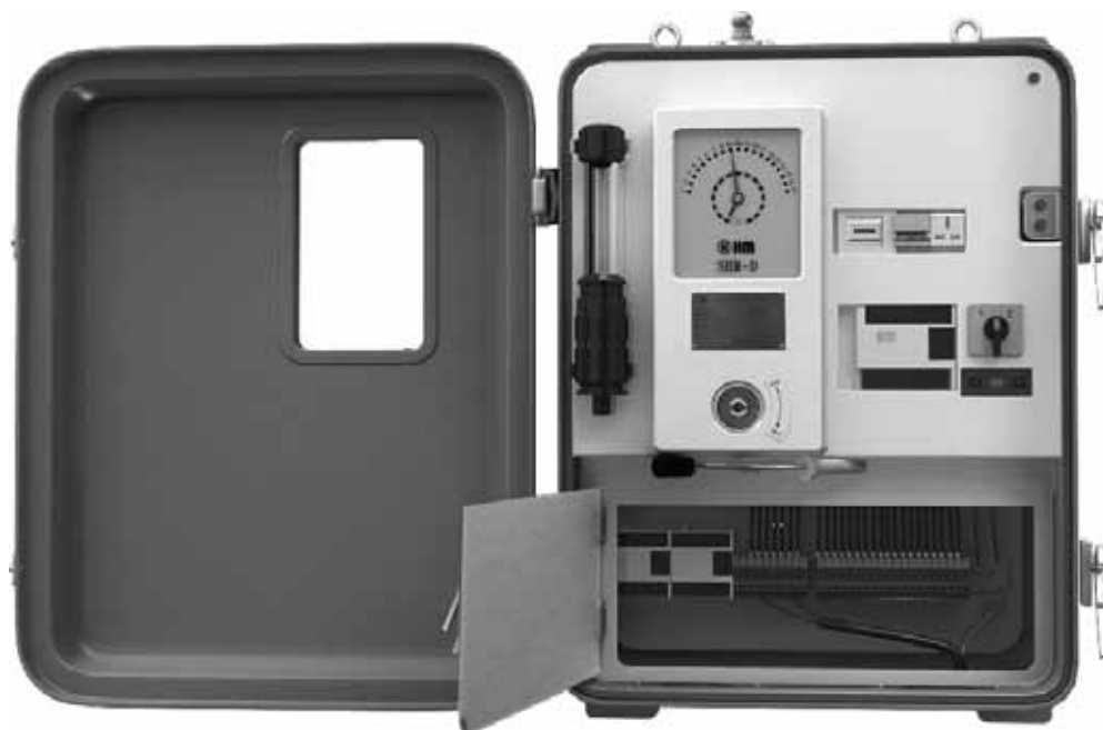
Рис. 1 Внешний вид моторного привода
