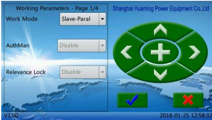
Блок управления SHM-K находится в местной сети. Ведущее устройство рассматривает состояние ведомого и принимает команды в режиме ручного параллельного регулирования или, основываясь на значениях выборки, в режиме автоматического параллельного регулирования. В это время команды передаются и на ведомое устройство.
