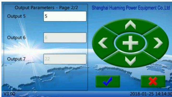
Значение каждого релейного выхода должно быть настроено в соответствии с реальными потребностями. По умолчанию первые шесть знаков BCD кода предназначены для назначения параметров вывода, а последний знак означает, что переключающее устройство находится в процессе работы. Таким образом, такими знаками являются 1, 2, 3, 4, 5, 6 и 22 соответственно.
