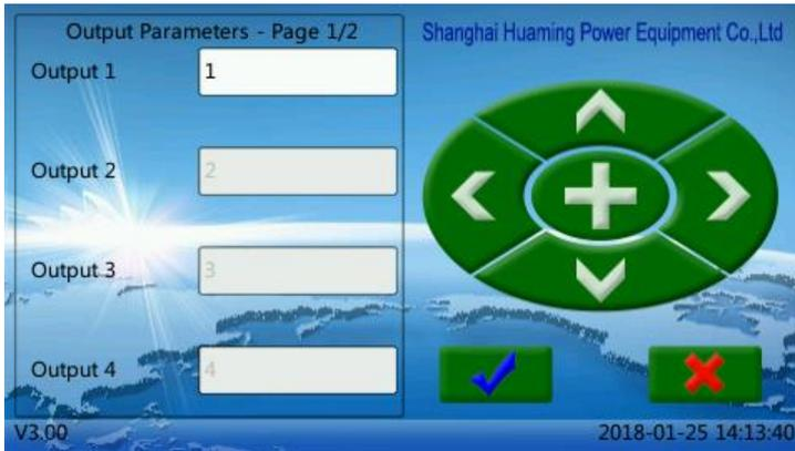
Пользователь может использовать кнопки "выше" и "ниже" на панели управления, чтобы изменять значения в настройках параметров, и использовать "+" для переключения различных вариантов для определения вывода.
