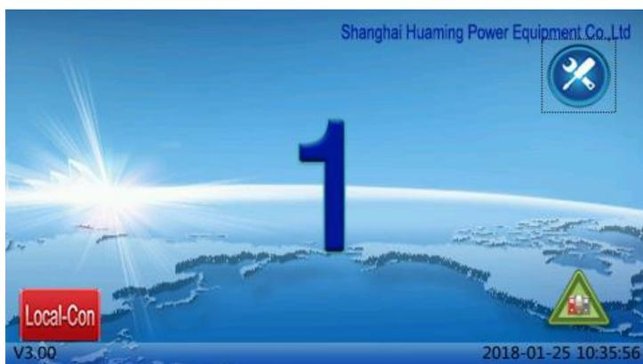
Управление «Выше, Ниже, Стоп» привода осуществляется в трех режимах - местный, дистанционный и цифровой. Режим выбирается переключателем, находящемся в корпусе привода (для привода типа SHM-D) или на панели (для привода типа SHM-DS).
