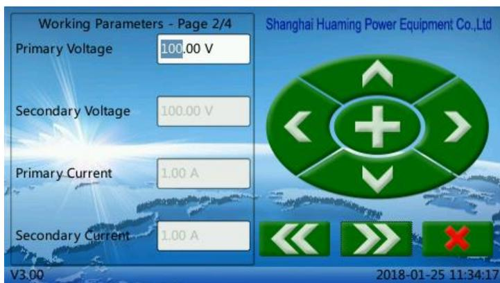
Значение вторичного напряжения, связанного со вторичным значением РТ блока SHM-K, а диапазон входного сигнала составляет от 10 до 456В. Значение вторичного тока, связанного со вторичным значением СТ блока SHM-K, а диапазон входного сигнала составляет от 1 до 5А. Нажмите “»»” для продолжения установки.
