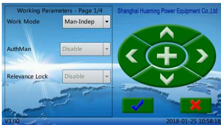
Кнопкой "+" в центре операционной панели можно переключить разные опции, кнопками вверх и вниз выбирают значения. После установки рабочие параметры следует сохранить с помощью нажатия кнопки подтверждения под панелью управления временем, а затем выйти из настроек.
