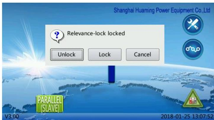
После подтверждения разблокировки символ блокировки становится серым. Это означает, что блокировка системы находится в состоянии разблокировки. В этот момент SHM-K находится в режиме параллельного ведомого регулирования, но устройство РПН может работать от кнопок выше/ниже/стоп на панели управления, от входных сигналов выше/ниже/стоп с заднего терминала и от протоколов связи.
