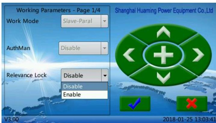
Блок управления SHM-K установлен в режим параллельного ведомого регулирования. Откройте функцию параллельной взаимной длокировки и разблокируйте параллельную работу. В это время, SHM-K временно перейдёт в режим ручного независимого регулирования.
