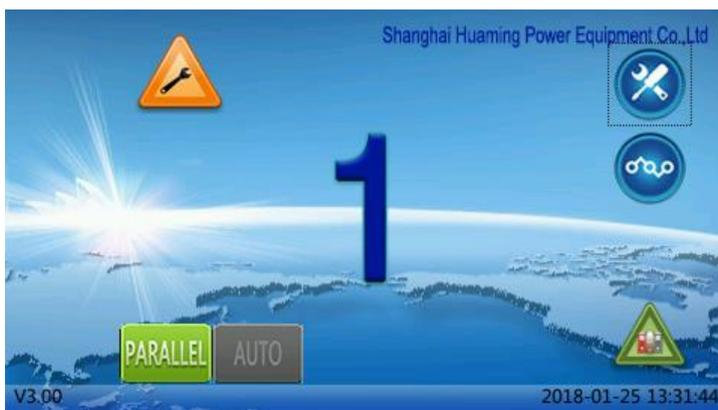
Щелкните на символ параллельной блокировки, чтобы разблокировать его.
