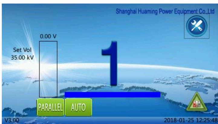
На другом примере при ручном параллельном регулировании значок "параллельное" зелёный, а "автоматическое" серый, что показывает о наличии только параллельной функции, как это показано на рисунке.
