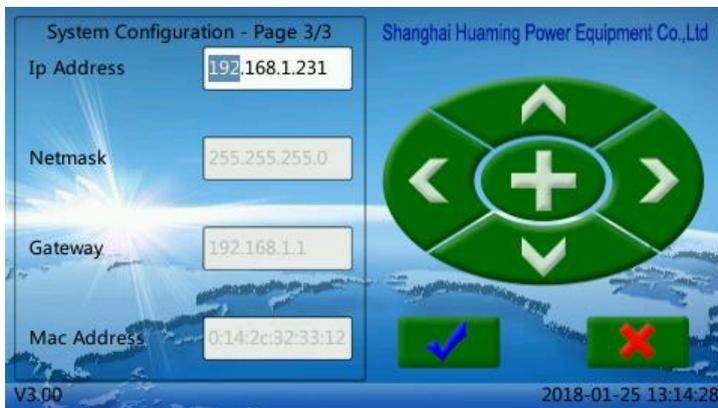
При поставке SHM-K с завода, каждому устройству система автоматически назначает IP-адрес и Мас-адрес. В общем случае пользователю не нужно специально задавать эти параметры. Однако, когда ведущее устройство в режиме параллельного регулирования сканирует ведомого, а блок SHM-K для параллельного ведомого регулирования отсутствует, пользователю необходимо обратить внимание на эти параметры и проверить сетевое соединение.
