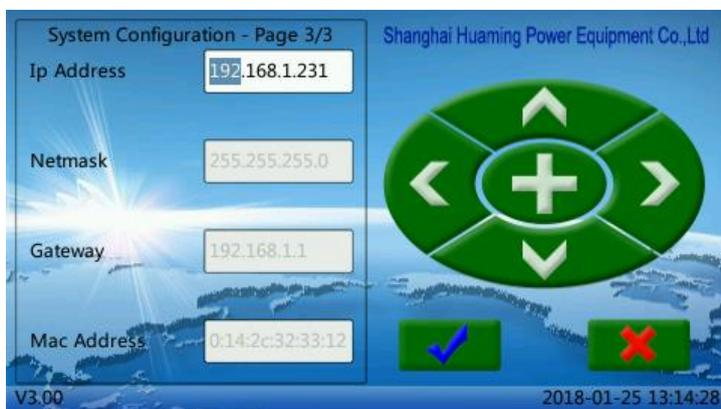
Все дистанционные блоки управления, работающие в режиме параллельного регулирования должны находиться в одной и той же сети и IP адреса не могут повторяться. В соответствии с соглашением TCP/IP, Мас-адреса также не могут повторяться.
