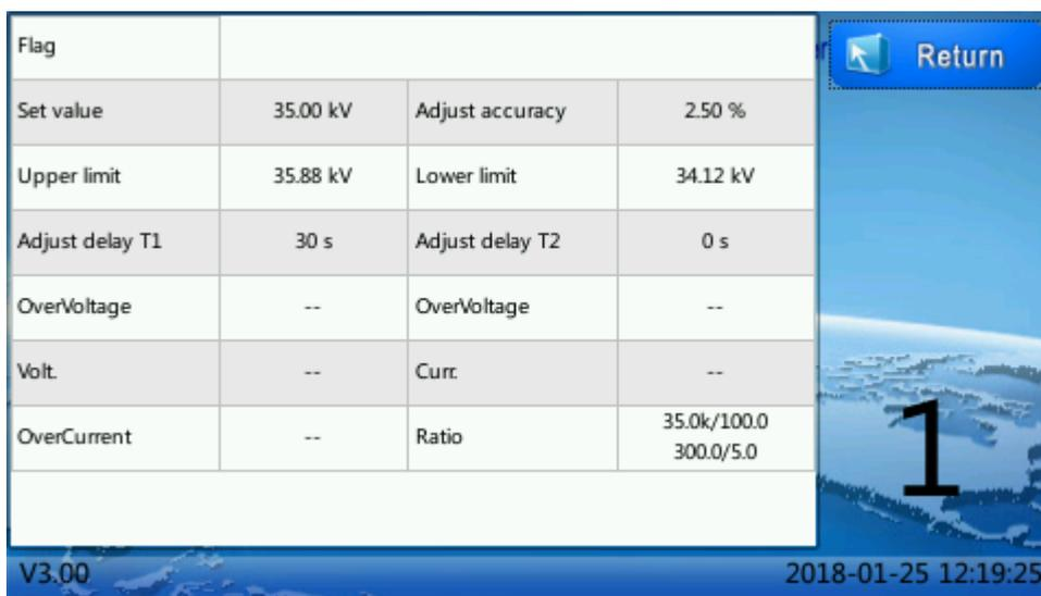
Верхнее предельное значение, указанное выше - это устанавливаемое значение параметра + устанавливаемое значение параметра x значение точности. Когда верхнее предельное значение будет превышено и задержка по времени установки превысит время T1+T2, блок управления SHM-K передаст команду на понижение положения.
