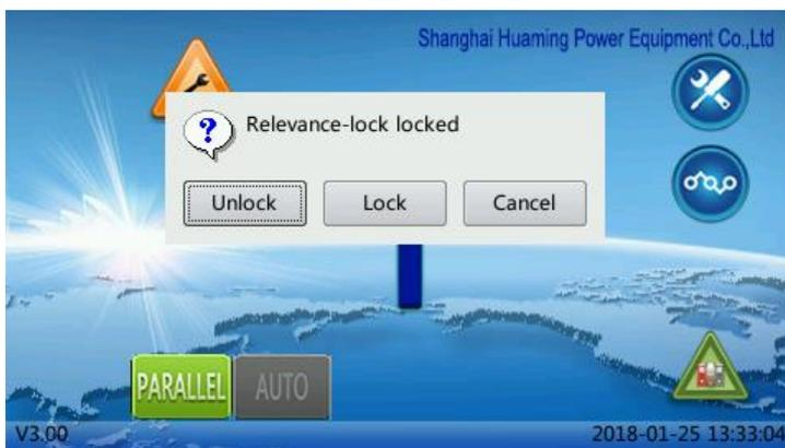
После разблокировки символ параллельной блокировки станет серым. Это означает, что система больше не определяет статус ведомого устройства и синхронизирован он или нет, а также определяет находится ли ведомое устройство в состоянии параллельного разблокирования или нет.
